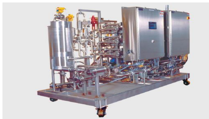
Imagen 7. Equipo de ultrafiltración de la empresa Gea (Alemania).
